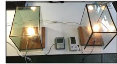
同じ容積の水槽に一方のみiQUEを貼り20Wのクリプトン電球を点灯させたときの庫内の温度上昇を比較。iQUEは輻射熱を反射させ温室効果を発生させるので、温度上昇が早い。冬場の節電にも効果あり。
