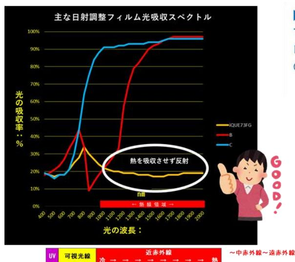
►iQUEフィルム(オレンジ色)は、熱を持たない領域では、光の吸収率は33%程度で、熱領域以上では、吸収率が逆に下がる傾向にあり、さまざまなガラスへの施工が検討可能になります。
